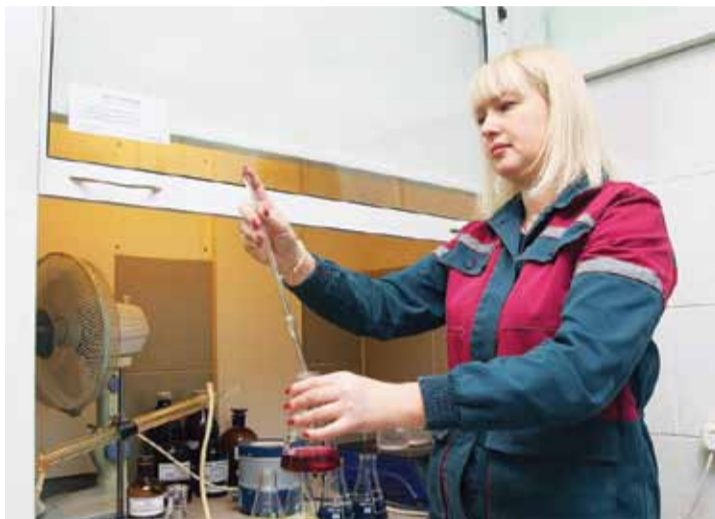
Лаборант химического анализа ОТК РУ-4 С.П.Русак определяет массовую долю цинка в концентрате калий-хлор.
